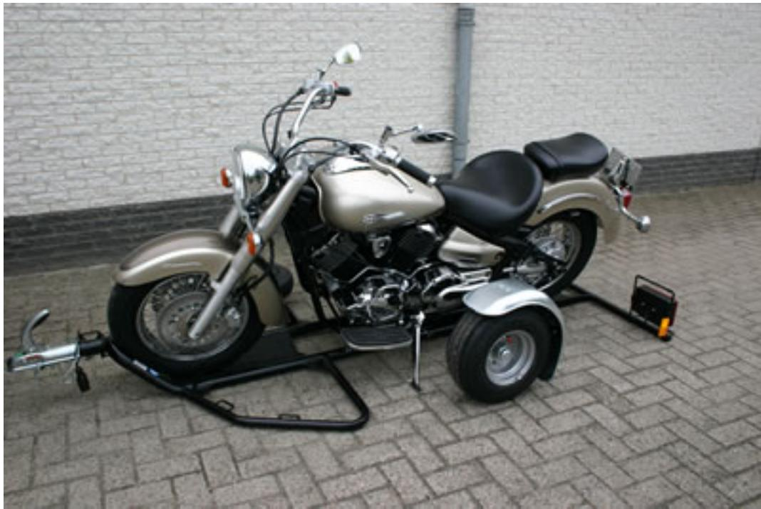
7. Spanngurte am Motorrad befestigen, zuerst auf der Seitenständerseite, das Motorrad mittels der Spanngurte aufrichten und Festzurren
