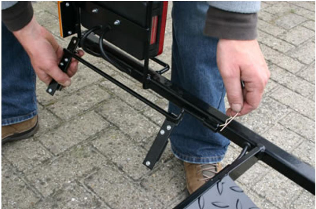
3. Den Sicherungsstift entriegeln (in Fahrtrichtung links), indem man ihn ein Stück herauszieht und ein Viertel dreht, damit der Anhänger ganz gesenkt werden kann.
