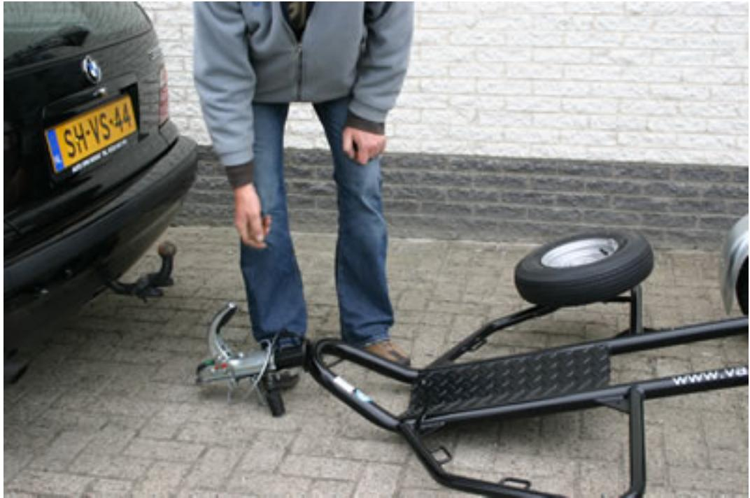
5. Das Ventil am Luftzylinder eindrücken damit die ganze Luft entweicht. Das Schwenkrad zum Schieben des Anhängers zur Seite drehen damit der Anhänger nicht darauf lastet.
